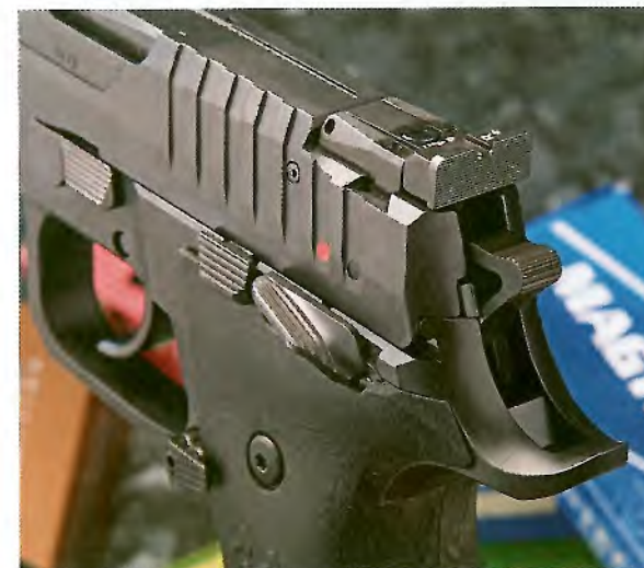
Hinten auf dem Schlitten sitzt in einem Schwalbenschwanz eine voll verstellbare Kimme mit geriffeltem Target-Blatt. Man beachte den Skeletthahn.
