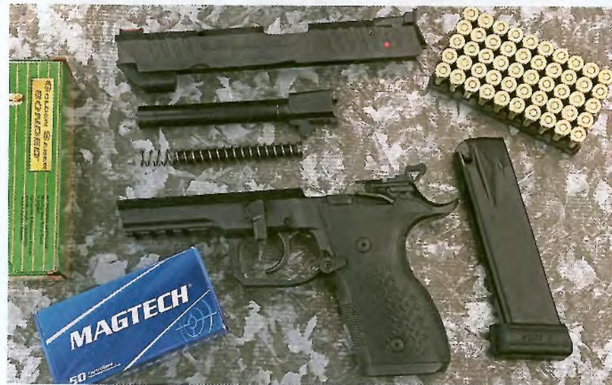
Herrsche über die Teile (v.o.): Verschlussgehäuse, Lauf, Vorholfeder-Set, Griffstück, Magazin. Wie der Lauf mit seinem Riegelblock und der unten offenen Steuerkulisse zeigt, wird per Browning-Petter-SIG-System verriegelt.
